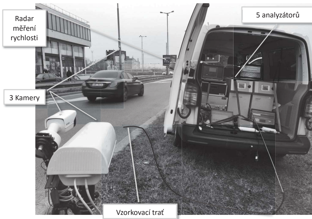
Obr. 2. Měření emisí částic projíždějících vozidel vzdáleným odběrem vzorku výfukového oblaku
